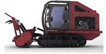
Ahwi: Raupen-Traktor RT200 mit Mulchfräse M500 und Stockfräse SF700 mit 65 cm breiter Fräuscheibe.
